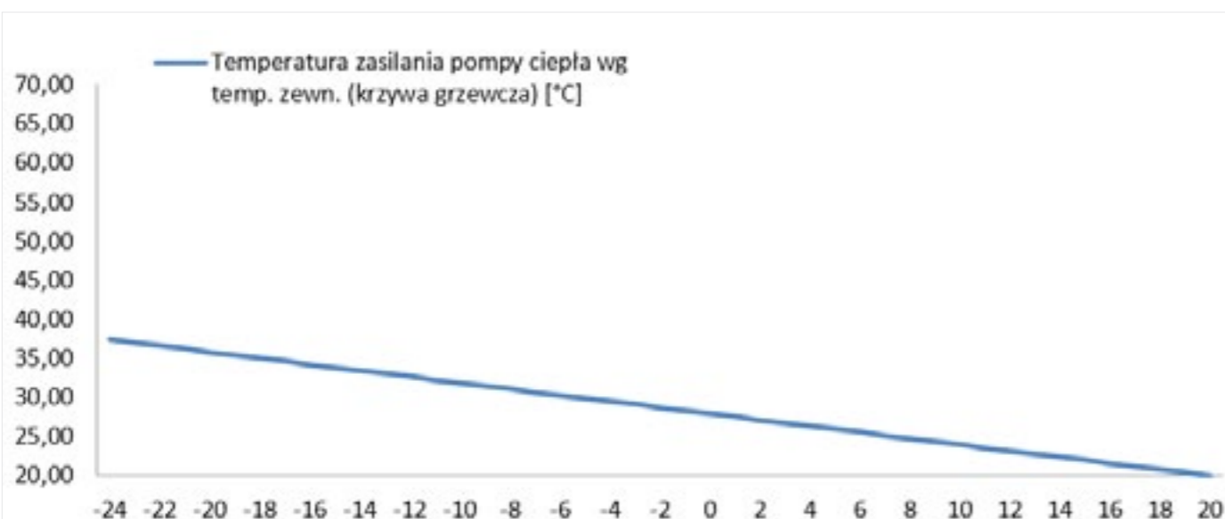
6 Temperatura zasilania systemu ogrzewania płaszczyznowego (podłógówka) w zależności od temperatury zewnętrznej analizowanego budynku
