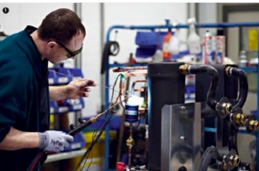
6 Nawet w urządzeniach częściowo zmontowanych, ostatnie połączenia muszą być lutowane. Każde połączenie musi być doskonałe, tak aby zapobiec ulatnianiu się czynnika chłodniczego
